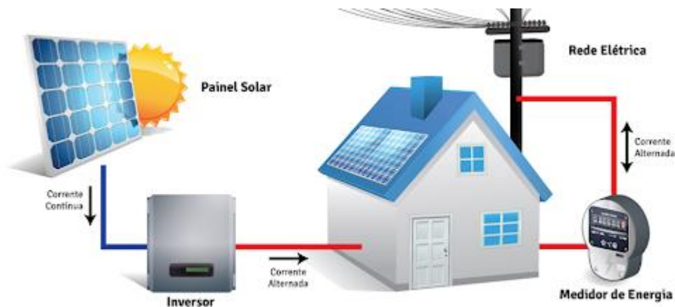
Figura 1 - Funcionamento de sistema fotovoltaico conectado à rede
