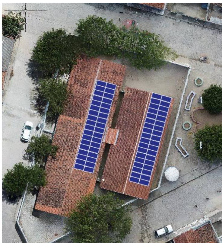
Figura 4. Layout proposto do sistema fotovoltaico da Escola Municipal de Ensino Infantil Sagrado Coração de Jesus
